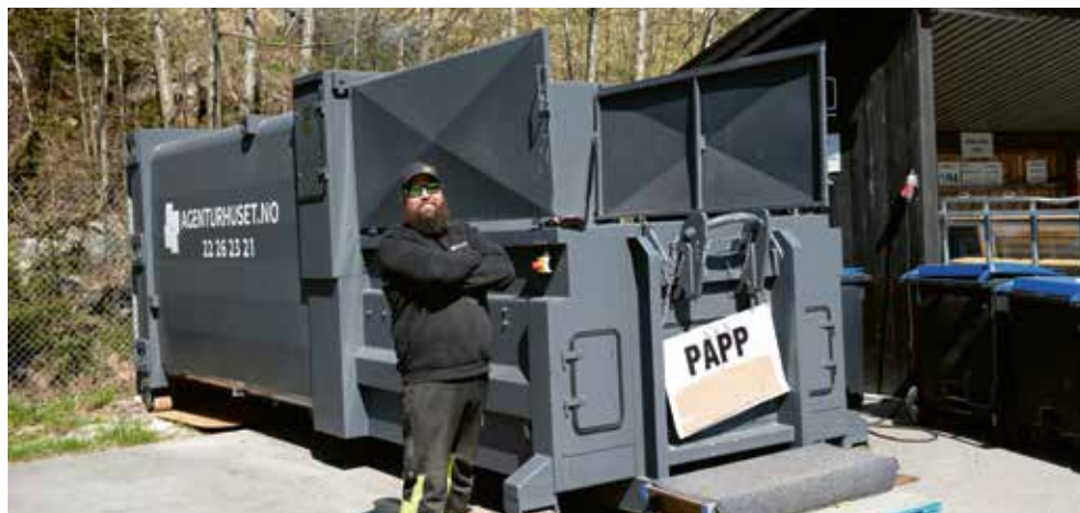
STEMPELET DYTTER PAPPEN INNOVER I ET LUKKET KAMMER MED 210 BARS TRYKK.
