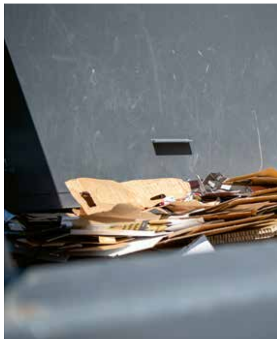
STEMPELET DYTTER PAPPEN INNOVER I ET LUKKET KAMMER MED 210 BARS TRYKK.
